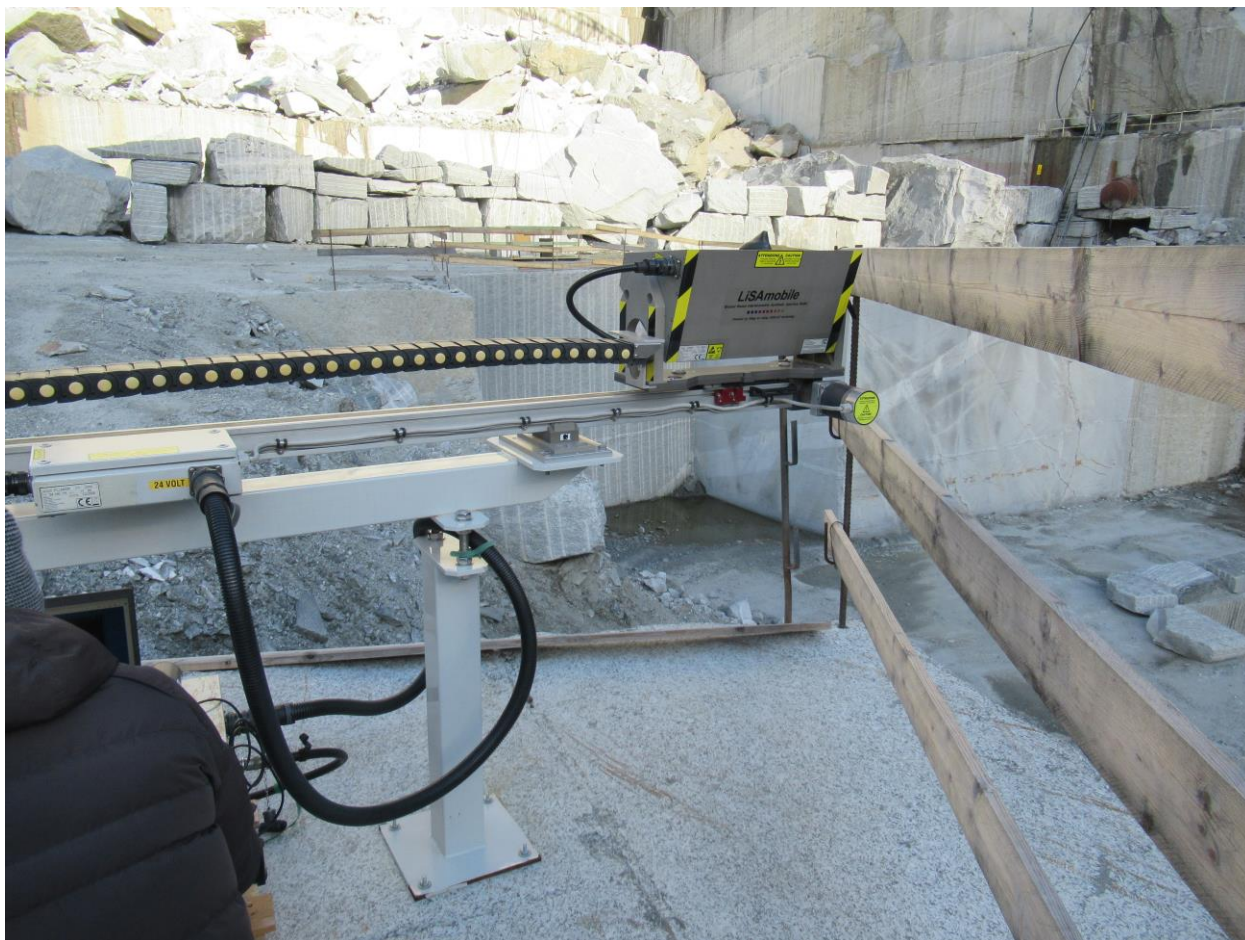
Figura 10: Postazione di misura del sistema GBInSAR LiSALab per il monitoraggio della cava di Bort; Febbraio 2024.
